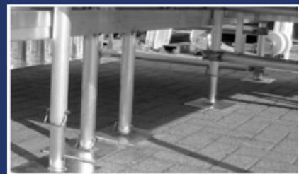
Mit den höhenverstellbaren Sockeln und einzelnen Plattformen (125 x 50 cm) kann unser Zwischenboden in jedem Raum individuell eingesetzt werden. Die maximale Belastung beträgt 250 kg / m<sup>2</sup>. Die Bauzeit beträgt für 30 m<sup>2</sup> nur ca. 15 Minuten!
