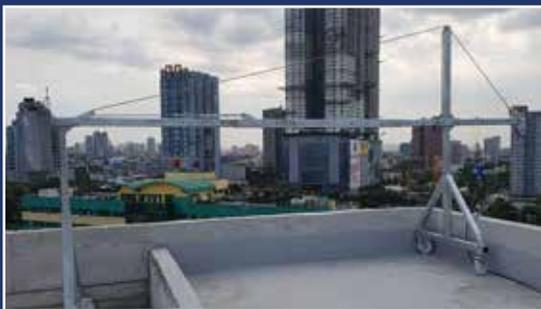
Alle modularen Komponenten des ASC HBI XP sind aus hochwertigem Aluminium gefertigt. Aufgrund der modularen Struktur kann praktisch jede gewünschte Länge mit der ASC HBI XP erreicht werden. Natürlich stehen auch auf Wunsch Winkelprofile zur Verfügung.
